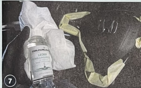
7 Die Entfettung des Leders besorgt ein spezielles, leicht flüchtiges Reinigungsbenzin
