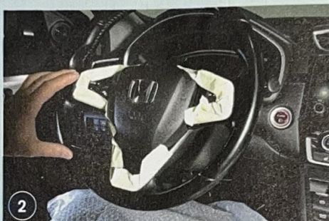
Abdecken und Abkleben schützen Kunststoffteile und Bekleidung vor Chemie
