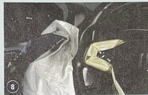
8 Entfettet wird, bis kein Schmutz mehr im Reinigungstuch zurückbleibt...
