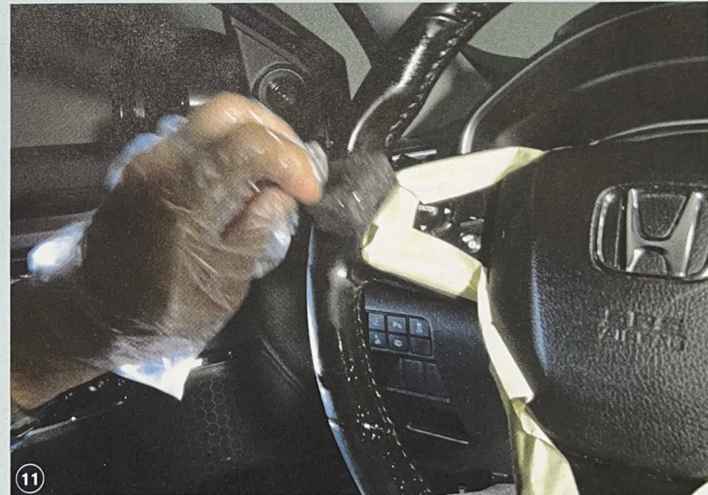
11 Nach dem Trocknen, etwa mit Heißluftgebläse oder Föhn, kann zwischengeschliffen werden
