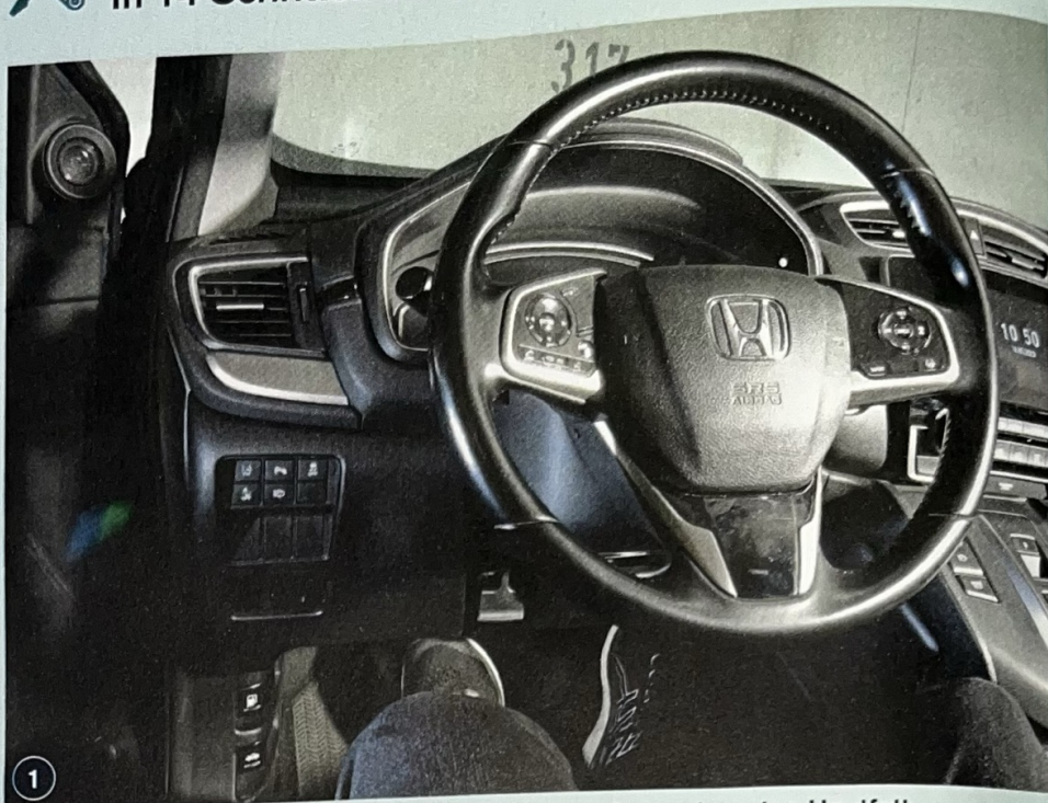
Glänzende, klebrige Stellen am Lenkrad deuten auf eingelagertes Hautfett der Fahrer hin
