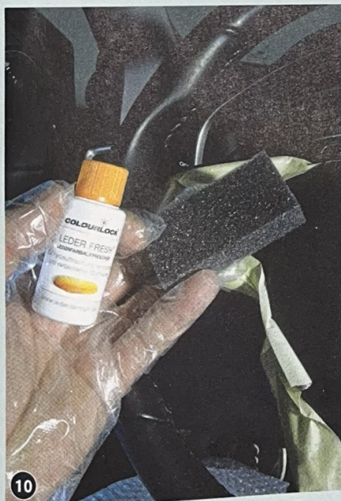
10 Nun wird in tupfenden Bewegungen die Leder-Auffrischungsfarbe aufgetragen
