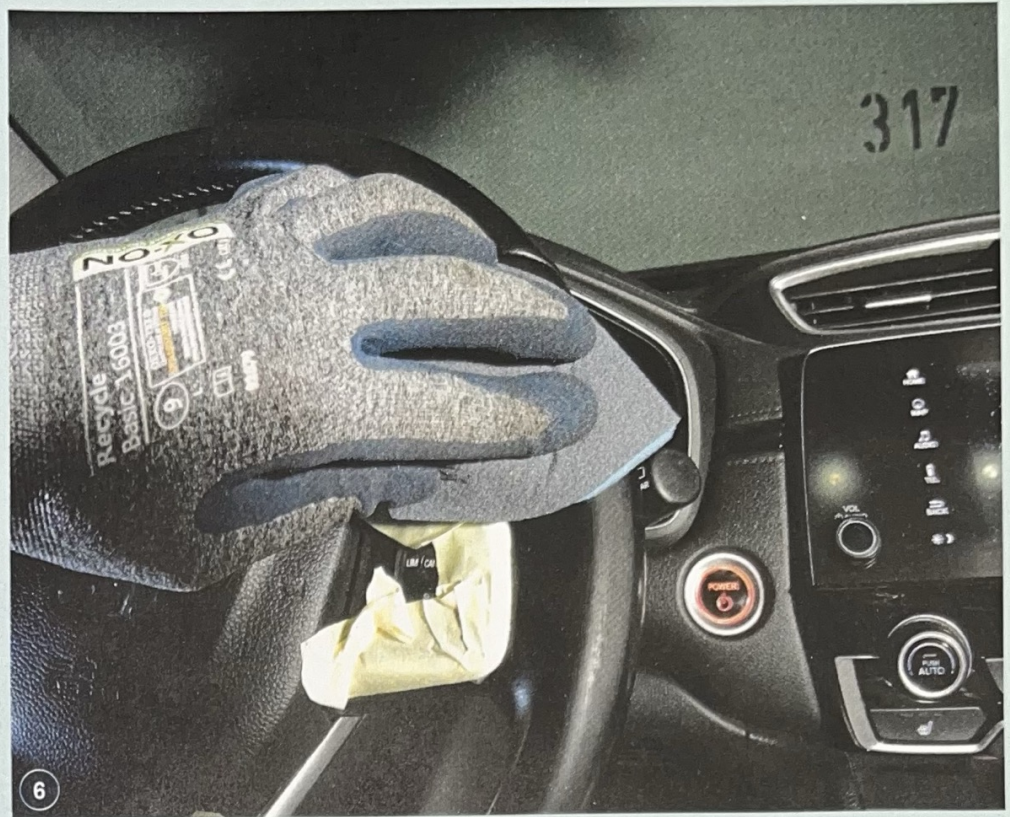
6 Mit einem Schleifpad wird nun das Leder aufgeraut und Kratzer glatt geschliffen. Ein Vorgang, der mehrfach erfolgen kann
