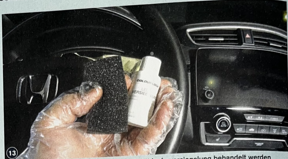
13 Matte Lenkräder können nun abschließend mit Lederversiegelung behandelt werden
