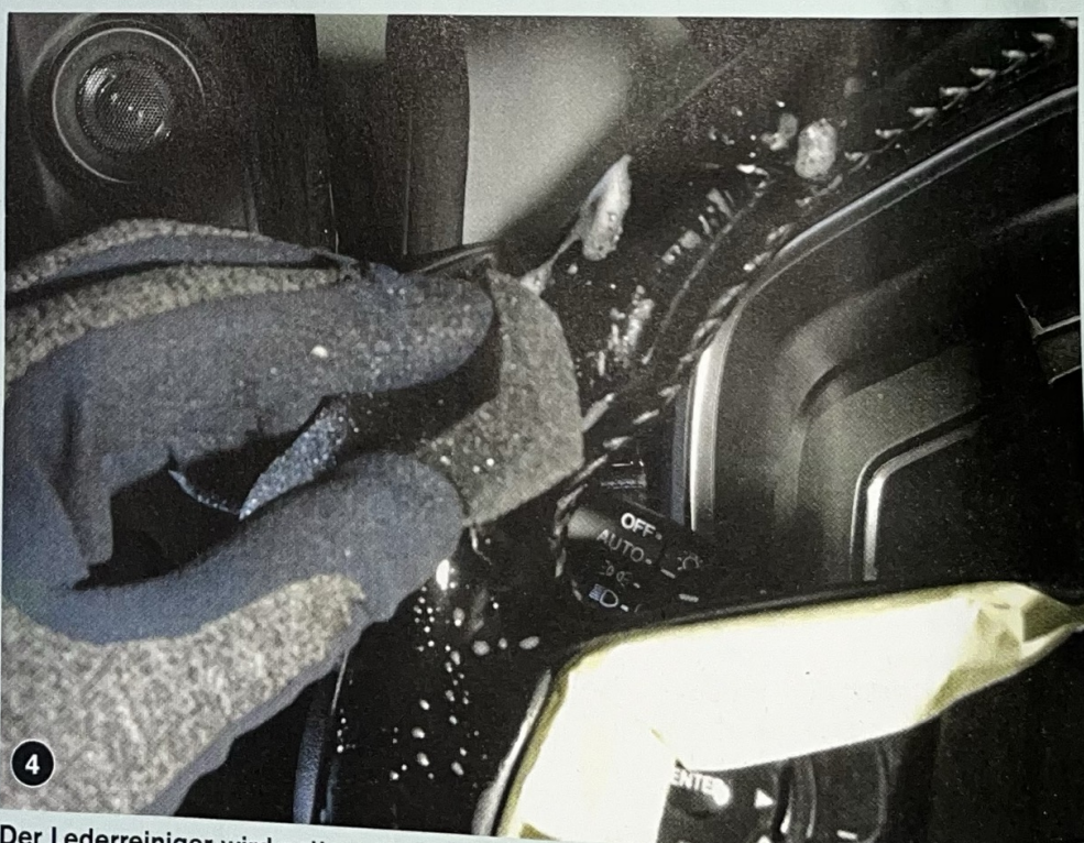
Der Lederreiniger wird satt und in kreisenden Bewegungen in das Leder einmassiert
