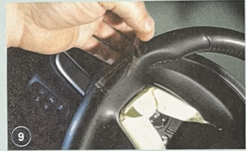
9 ... und die Lederoberfläche den Tesa-Test besteht
