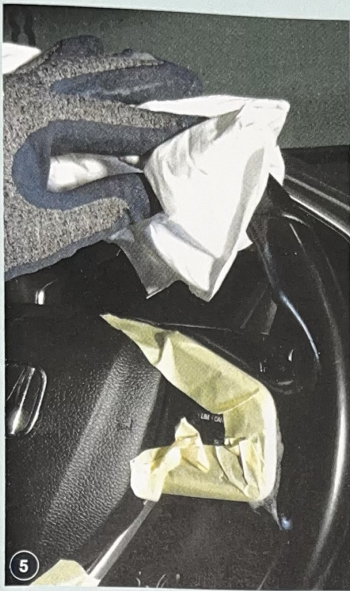
5 Mit einem Vliestuch werden überschüssiger Reiniger und Schmutz entfernt
